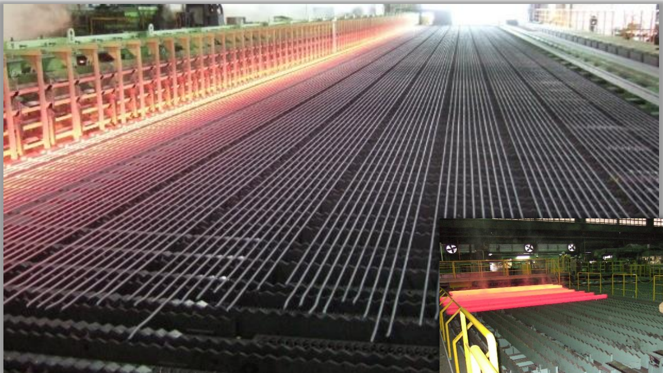
垂直落下式トラフ & 冷却床及び集積コンベア(ランアウトテーブル)
