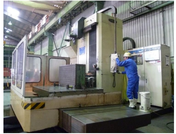
■ 横中繰フライス盤 東芝機械製R-16
