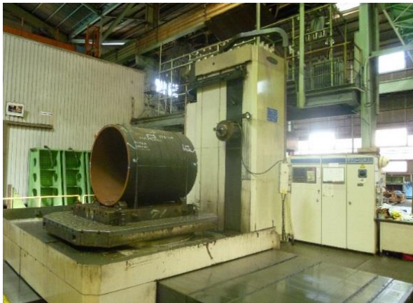
■ 横中繰フライス盤 東芝機械製R-22
